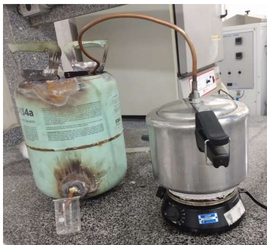
Figura 1. Hidrodestilador experimental montado no LTA/CCTA/UENF
