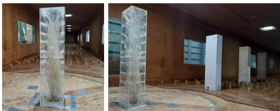
Figura 2. Modelo reduzido do CAARC e representação de uma configuração no interior do túnel de vento Fonte: elaborado pelo autor
