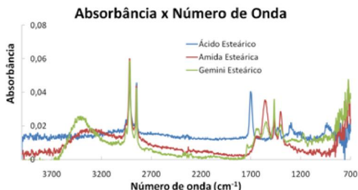
Figura 2. Espectros de FT-IR do ácido esteárico, da amida esteárica e do surfactante gemini obtido a partir da amida esteárica.
