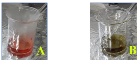
Figura 1: Extrato de hibisco em solução: (a) ácida de HCl; (b) básica de KOH.
