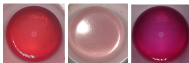
Figura 3: Hibiscus em água deionizada (a); Pigmentação em iogurte (b); Hibiscus em álcool 95% (c). Fonte: Imagens autorais. 2023.
