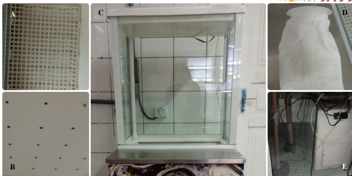
Figura 1. Expositor de moluscos vivos. (A) Cuba com grade para armazenar os moluscos; (B) Placa superior perfurada; (C) Vista frontal da parte superior do expositor; (D) Filtro bag e (E) Gabinete inferior contendo o reservatório com duas bombas de água ao lado do resfriador.
